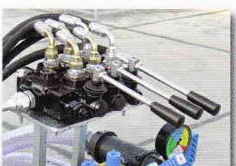
Distributore idraulico manuale a leve per i movimenti della barra
