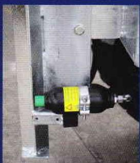
Ammortizzatore con accumulatore d'azoto
