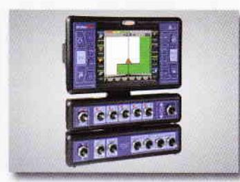
Computer con navigatore satellitare GPS per la distribuzione del prodotto e comandi elettro-idraulici per i movimenti della barra
