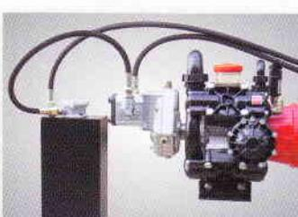
Pompa idraulica con serbatoio e filtro olio
