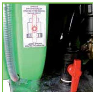
**Dispositivo per il lavaggio del circuito**
