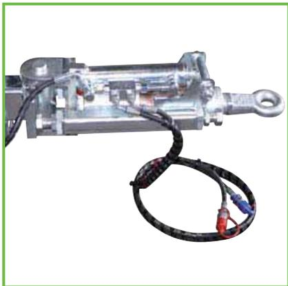
**Timone snodato con pistone idraulico omologato per la circolazione stradale (solo per l'Italia)** - Articulated drawbar with hydraulic cylinder type-tested for the road circulation (only for Italy) - Timon articulé avec vérin hydraulique homologué pour la circulation routière (seulement pour l'Italie) - Knickdeichsel mit Hydraulikzylinder mit Straßenverkehr-Zulassung (nur für Italien)
