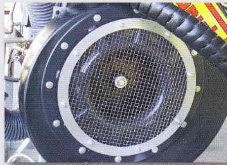
Ventilatore centrifugo a turbina
