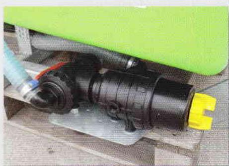
Dispositivo di lavaggio del circuito. Filtro di aspirazione esterno con valvola
